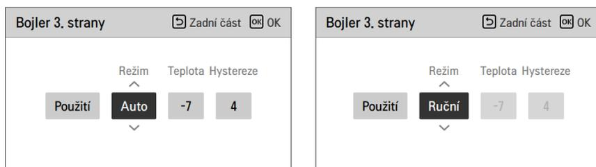
Je-li režim této funkce nastaven na „Auto“, můžete příslušným způsobem nastavit teplotu kotle a hysterezi.
